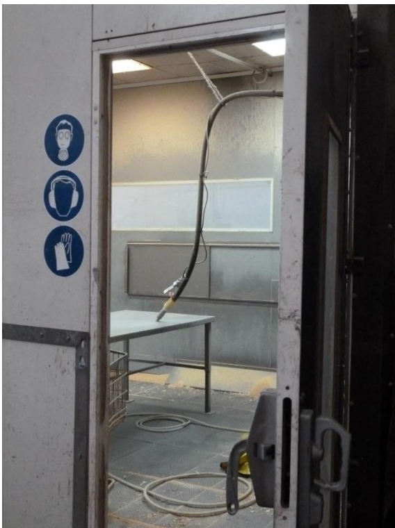
Photo 6 (à gauche) : Intérieur de la cabine de décapage végétal. Ici, le plancher aspire la poussière et les résidus de particules qui sont ensuite triés et recyclés.
