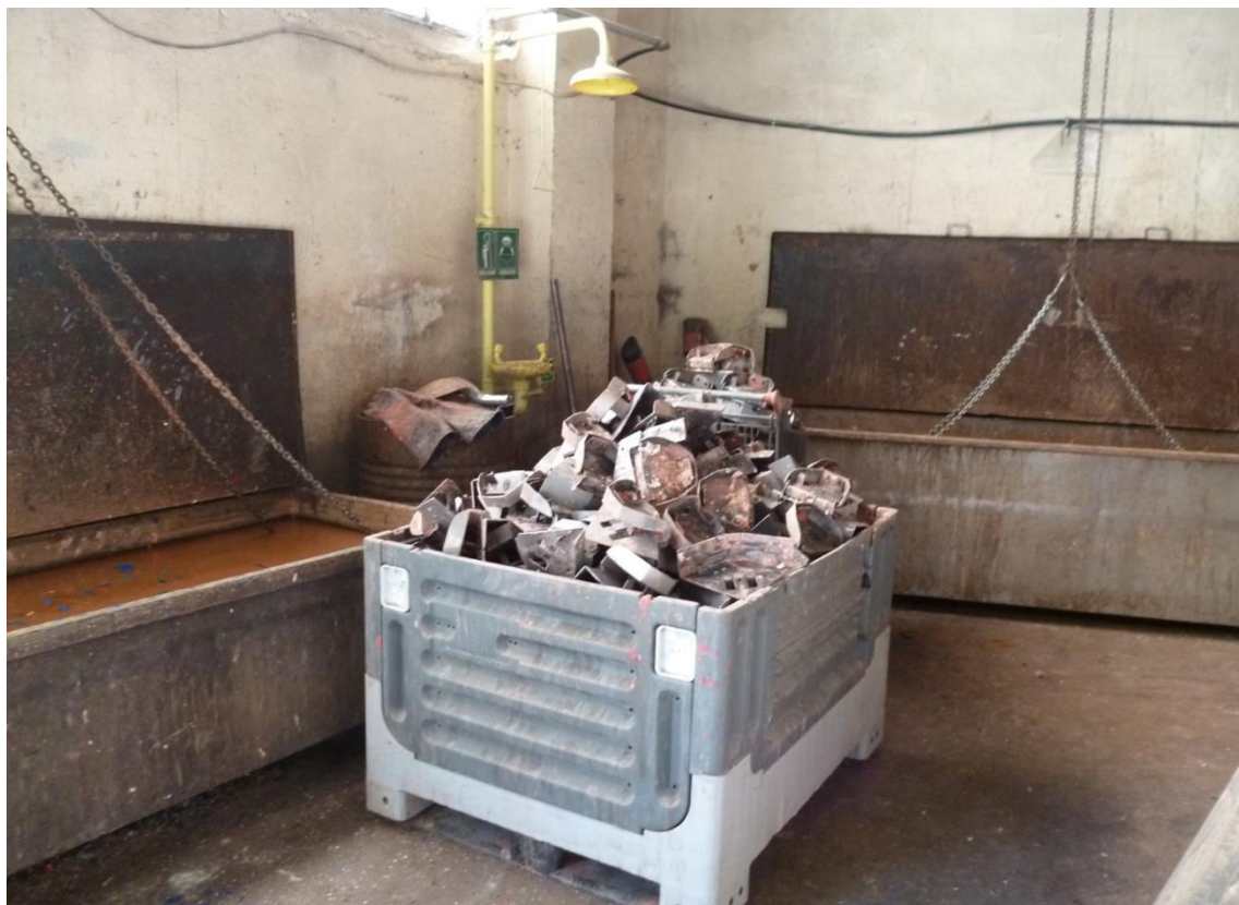
Photo 11 : Cuves de solvants avec un bac de pièces décapées.
