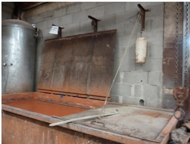
Photo 13 : Cuve de solvant dont un des couvercles est fermé. Les ouvriers ne ferment les cuves que la nuit.
