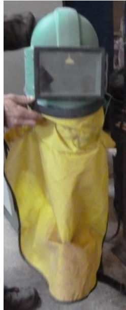
Photo 7 : Équipement de protection complet que portent les ouvriers dans les cabines de décapage. La respiration se fait au moyen d'un tuyau à oxygène.
