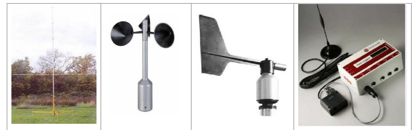
Capteurs du mât de mesures (source : Venathec)
