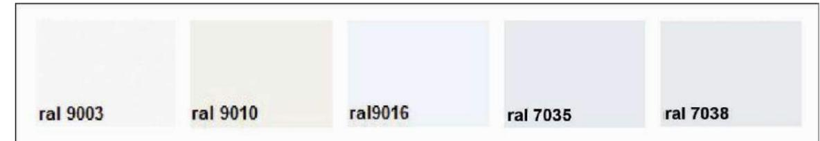
Figure 11 : Principales références RAL utilisables par les constructeurs d'éoliennes.
