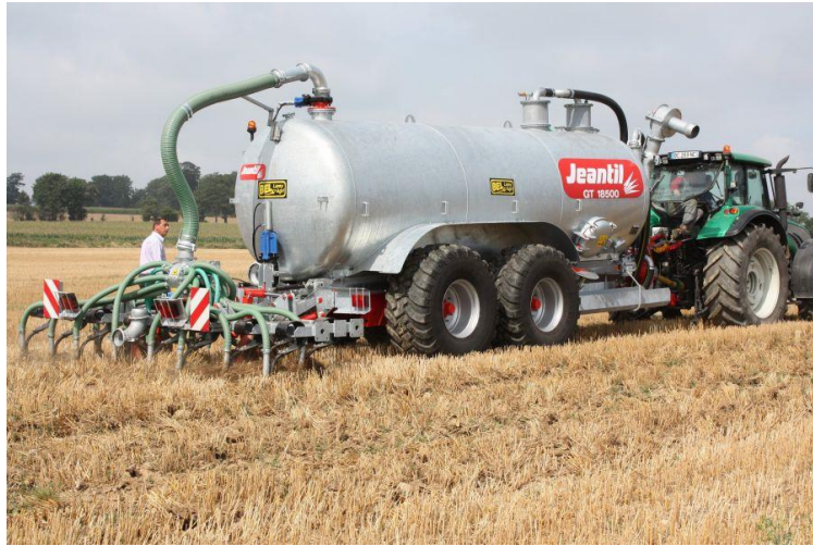
Figure 69 : Épandage avec une tonne munie d'enfouisseurs
