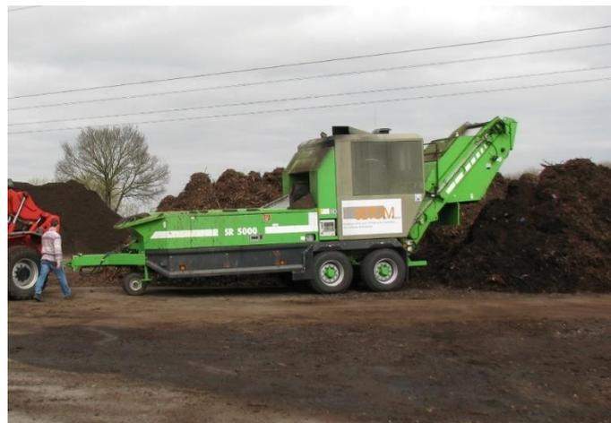
Figure 12 : exemple de broyeur de déchets verts
