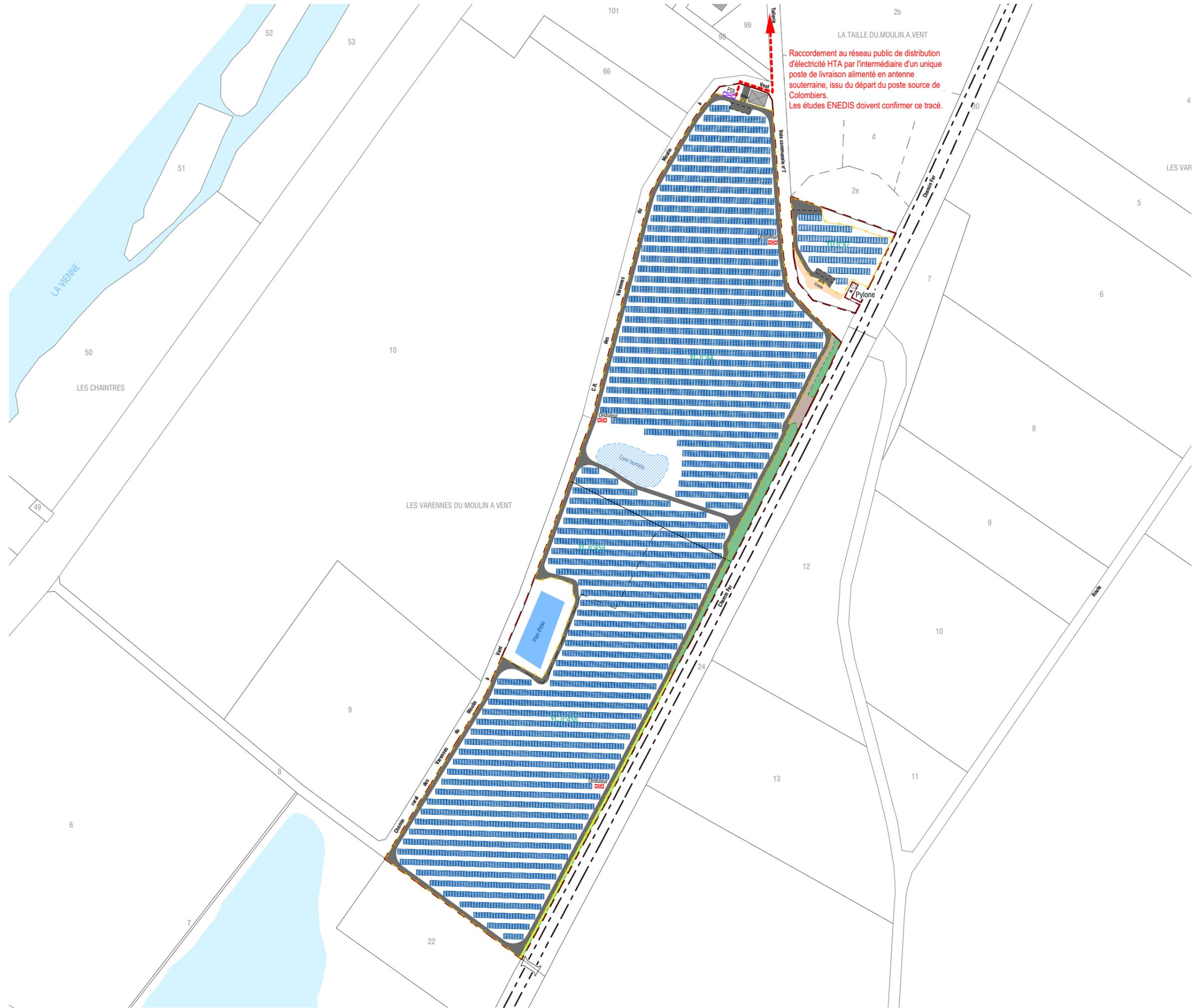
Raccordement au réseau public de distribution d'électricité HTA par l'intermédiaire d'un unique poste de livraison alimenté en antenne souterraine, issu du départ du poste source de Colombiers.
