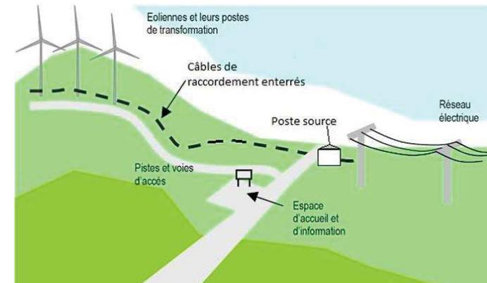
Figure 22 : Schéma descriptif d'un parc éolien
