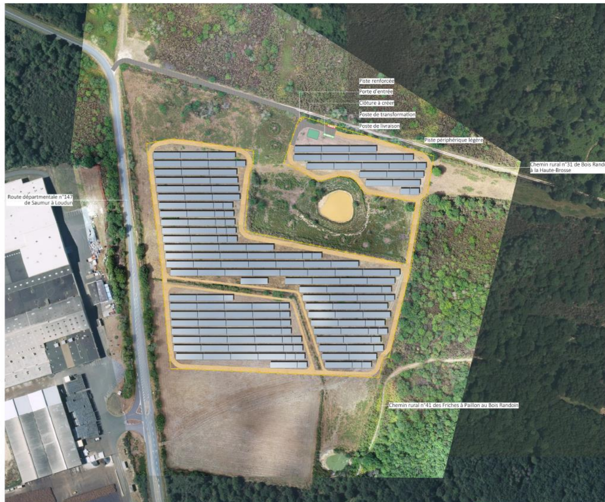
Figure 6 : Plan du projet de centrale photovoltaïque de Roiffé
